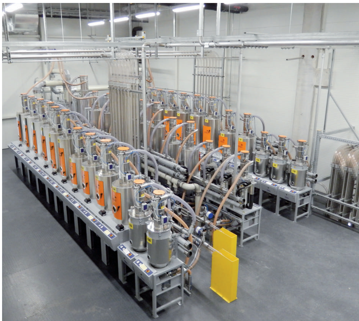
Sušilni sistem s tehnologijo ETA plus omogoča vzdrževanje optimalne temperature in pretoka zraka, s čimer prihranimo 64 odstotkov energije
