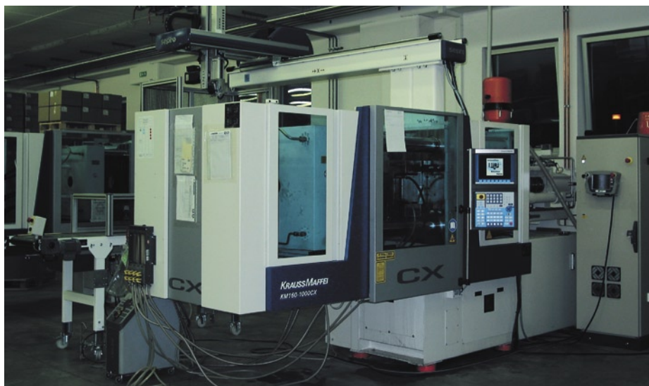
Novi stroj Krauss Maffei za brizganje plastike
