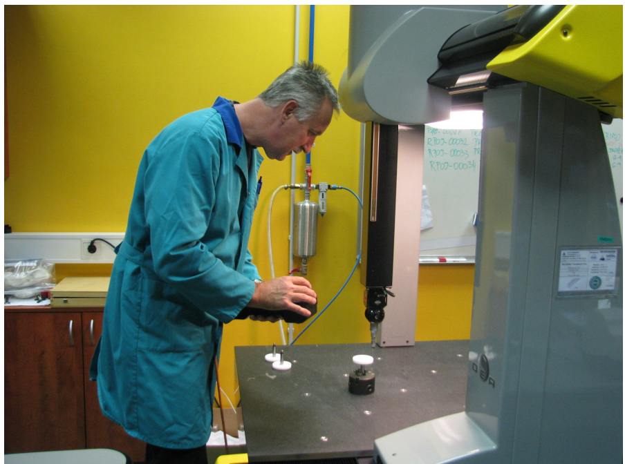
Bojan pri izvajanju dimenzijske meritve izdelkov na 3D merilnem stroju
