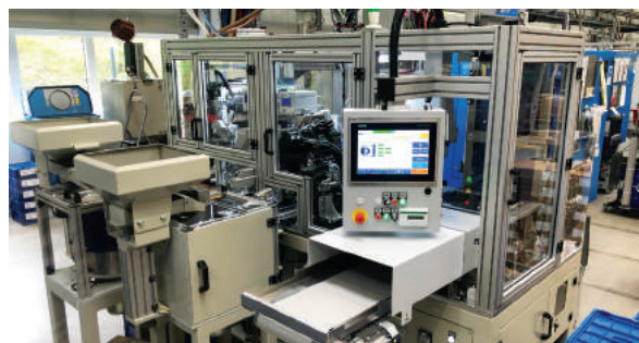
Trenutna kapaciteta avtomatizacije telescopic tube je omejena z zmogljivostjo brizgalnega stroja, ki je od 2 do 2,5 milijona kosov na leto.
