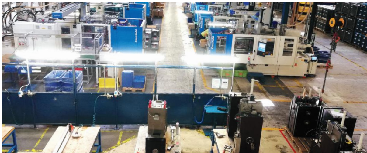
Proizvodna hala v Črnomlju se je v zadnjih letih dodobra napolnila – trenutno je na lokaciji 31 strojev v razponu med 80 in 500 ton. Šest jih omogoča dvokomponentno brizganje.
