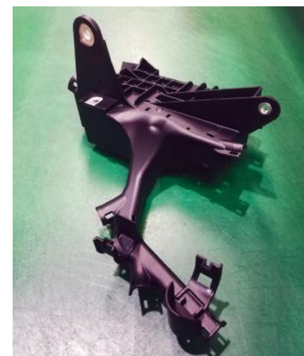
Izdelek Hauptschacht (kupec Nexans) vsebuje dva tipa insertov, ploščico z zavihki in okroglo pušo (desno). Na 500-tonskem brizgalnem stroju inserte v dvognezno orodje vlagamo s pomočjo zahtevnega avtomatiziranega sortirno-podajalnega sistema in prijemala. Na levi sliki je prikazan razvrstilni sistem za inserte s SCARA robotom, ki se prav tako uporablja za izdelke kupca Nexans.
