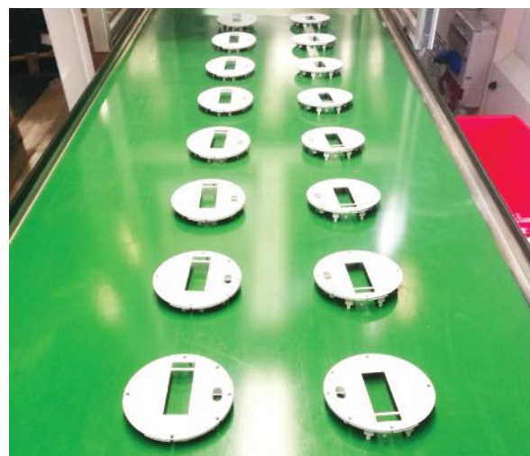
Ohišja pametnih vodnih števcov Water housing (levo) in pokrov za ohišje Frontcover (desno), ki ju proizvajamo za dansko podjetje Kamstrup.
