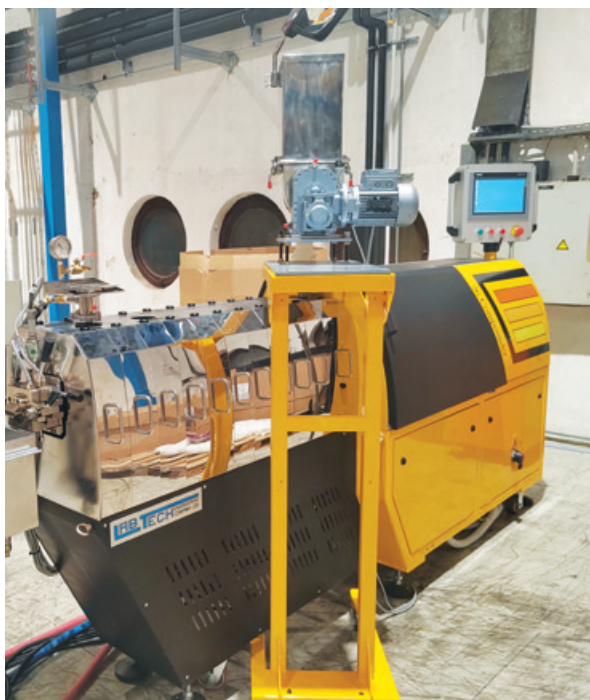
Pogonski sistem stroja v Črnomlju omogoča vrtljaje polžev do 800 vrtljajev na minuto.
